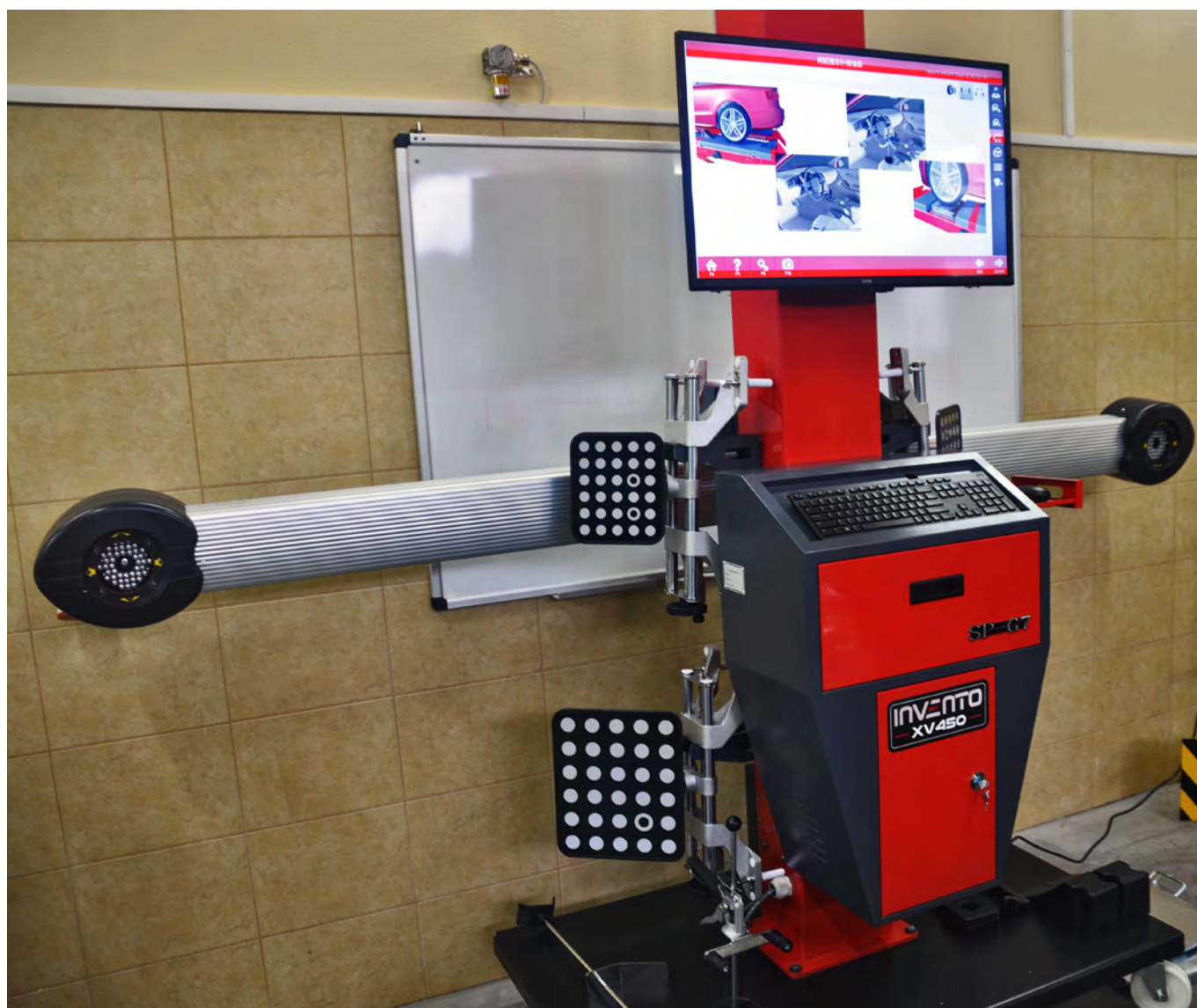
Urządzenie do kontroli geometrii kół i osi pojazdów samochodowych
