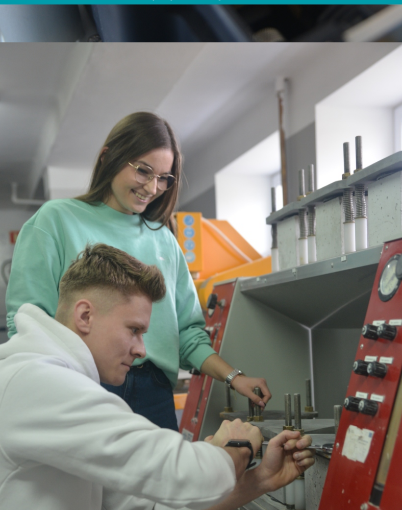
Urządzenie do pomiaru głębokości penetracji wody w betonie
