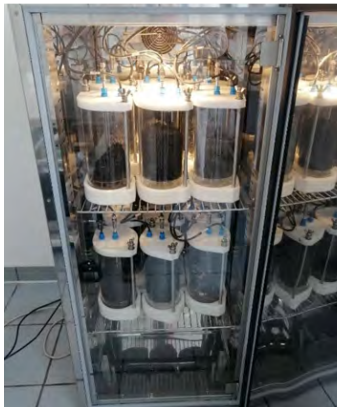
Rys. 2. Testy biodegradacji polimerów w respirometrze (źródło: Katedra Inżynierii Środowiska i Biotechnologii; J. Włóka)
