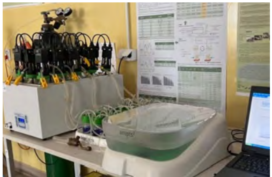
Rys. 1. Stanowisko badawcze do prowadzenia testów BMP – AMPTS II. Oznaczanie potencjału metanogenego (źródło: Katedra Inżynierii Środowiska i Biotechnologii; A. Czapnik)
